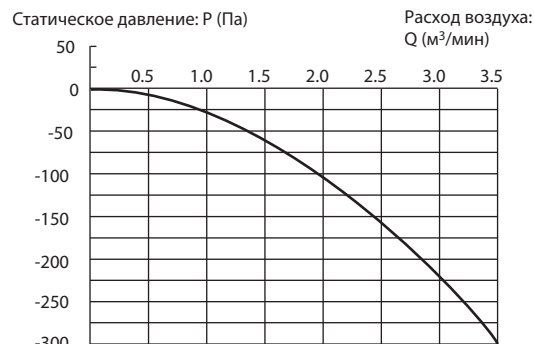
Расход приточного воздуха (подача воздуха в блок)
