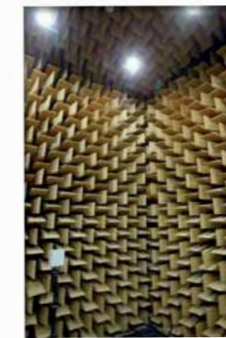
Реверберационная камера (проверка шумовых характеристик)
