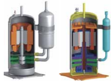
Распределенная обмотка Нераспределенная обмотка
