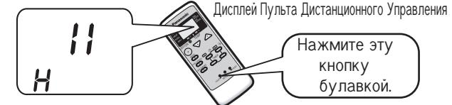
Нажмите кнопку TEMP UP или Down, чтобы распознать код ошибки. При правильном выведении кода ошибки на дисплей раздается звуковой сигнал (4 раза). Сообщите авторизованному дилеру код ошибки. Если на дисплее один из приводимых ниже кодов, допускается временная работа кондиционера.
