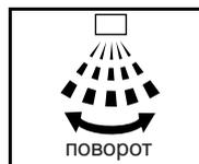
Если индикатор **НАПРАВЛЕНИЕ ВОЗДУШНОГО ПОТОКА** показывает поворот лопастей, в соответствии с приведенным ниже рисунком, направление воздушного потока меняется непрерывно. (Настройка автоматического поворота)
