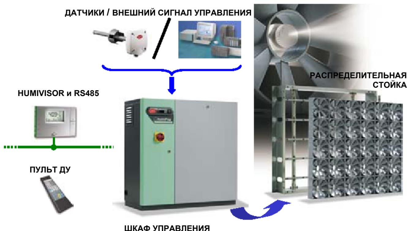
При понижении уровня влажности воздуха в помещении ниже требуемого значения или при поступлении сигнала от внешней системы управления, контроллер включает насос, обеспечивающий поступление деминерализованной воды на распределительную стойку. Под давлением 20-80 бар вода проходит через отверстия форсунок ( $\varnothing$  макс = 0,20 мм) и превращается в тонко дисперсный аэрозоль, который быстро испаряется в воздухе (средний **диаметр капель** водяного аэрозоля составляет не более **10-20 мкм**).
