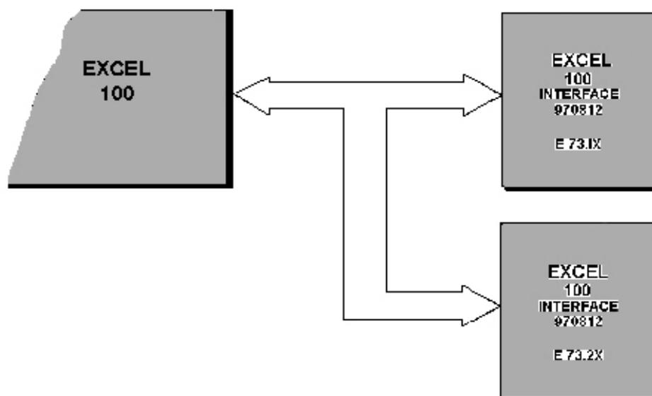
Рис.3.2. Контроллер EXCEL 100 показан с интерфейсными платами (E73.1X и E73.2X).
