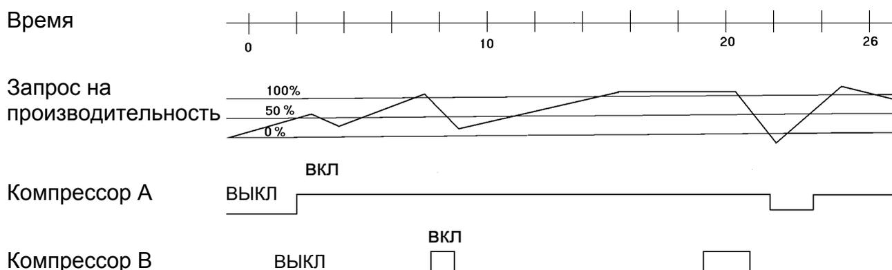
Рис.2.3. Производительность теплового насоса регулируется минимально коротким рабочим циклом.
