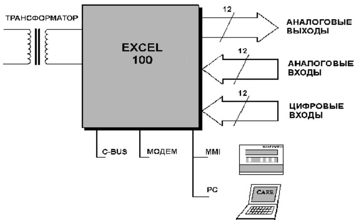
Рис.3.1. Схема внешних соединений контроллера EXCEL 100.
