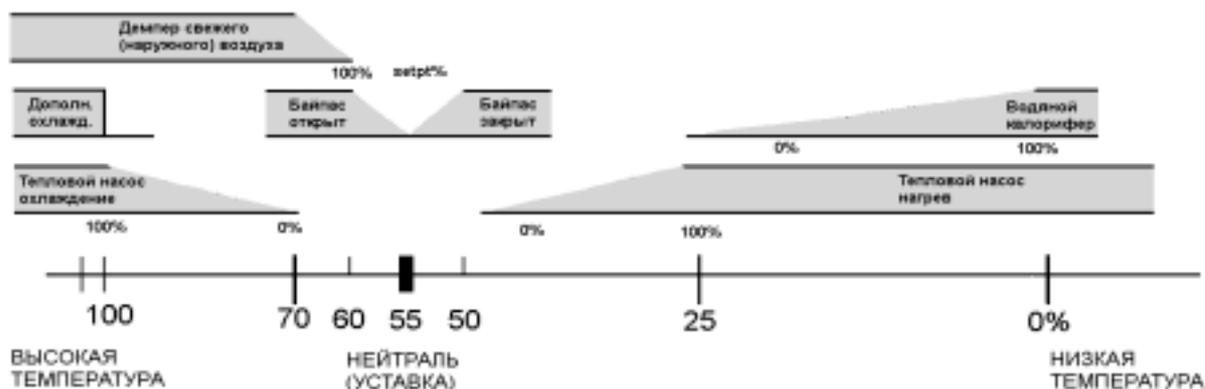
**Рис.2.1.** Потребность помещения в нагреве и охлаждении регулируется в пределах от 0 до 100%. Компоненты вентиляционного агрегата управляются в показанной последовательности.
