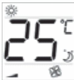
Рис. 2.m.h Вид дисплея с активированным режимом ожидания (SLEEP)
