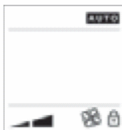
Рис. 2.m.i Вид дисплея с активированной удаленной блокировкой
