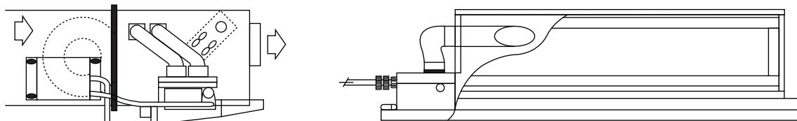
3. Установите оба патрубка (воздухозабор и парораспределитель) в воздуховод и надежно закрепите.
