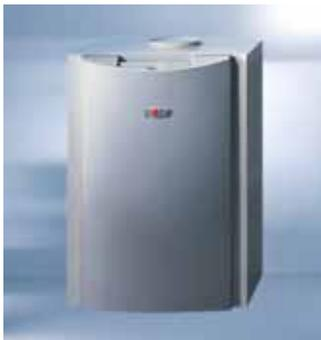
Напольный бойлер-водонагреватель TSW-120 из стали с двойным внутренним эмалированным покрытием. Подключения и отверстие для чистки расположены на верхней поверхности бойлера, слив воды – на нижней. Обшивка бойлера окрашена методом порошковой окраски (цвет RAL 9016). Защита от коррозии благодаря двойному слою эмали на стенках и теплообменнике бойлера, в соответствии с DIN 4753 часть 3. Дополнительную защиту от коррозии обеспечивает магниевый защитный анод.
