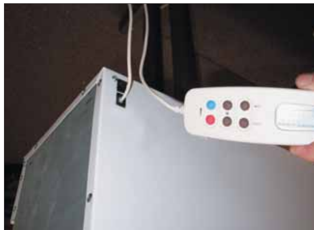
Рис. 67. Подсоединение пульта ДУ к гнезду
