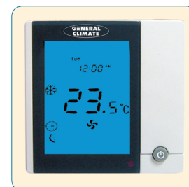
GR2010DA-T74RL Электронный термостат с таймером на 7 дней, регулятором скорости вентилятора и 3-х ходового клапана (2-х трубные фанкойлы). При достижении в помещении заданной температуры термостат перекрывает клапан. Вентилятор продолжает работать.
